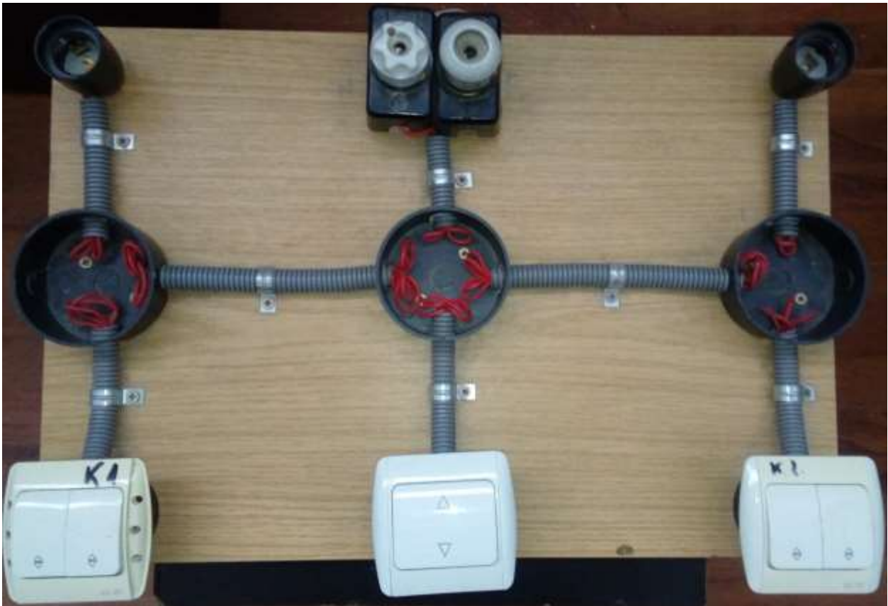
Panoplie demonstrativă pentru instalație electrică de iluminat și prize 2
